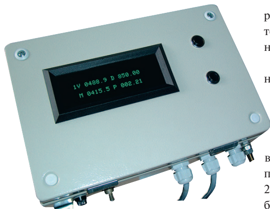
Рис. 2. Блок контроля топлива в базовой комплектации (БКТ 2.2)
