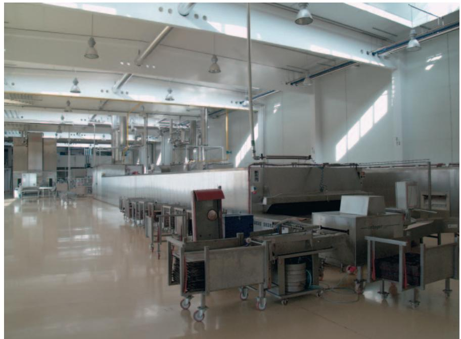
**Рис. 1. ТунNELНАЯ хлебопекарная печь, установленная в одном из цехов завода в Маркграфнойзидле, работает под управлением ПЛК VIPA**
