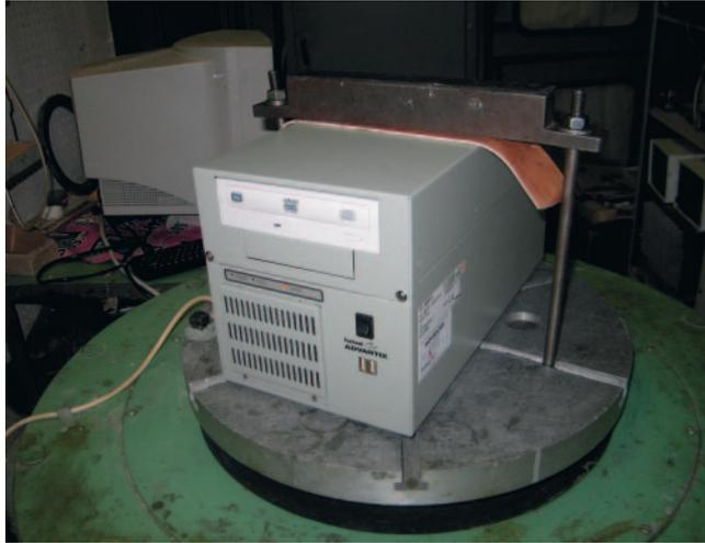
Рис. 22. Испытания AdvantiX ER УВМ1 на вибростенде
