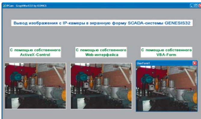
Рис. 3. Результат вывода изображения с IP-видеокamеры в экранную форму GraphWorX
