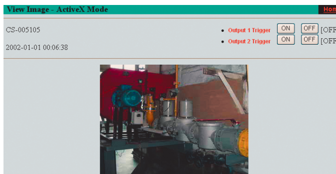
Рис. 5. Встроенный Web-интерфейс IP-видеокамеры
