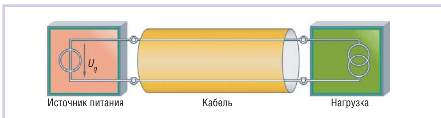
Рис. 3. Электрическая схема DART Power преднамеренно упрощена и содержит только источник питания, кабель и полезную нагрузку
