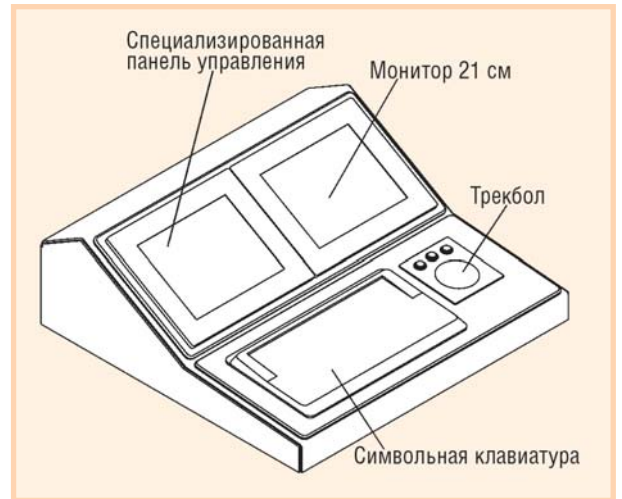
Рис. 4. Модульная конструкция консоли (монитор и специализированная панель управления могут устанавливаться в различных сочетаниях)
