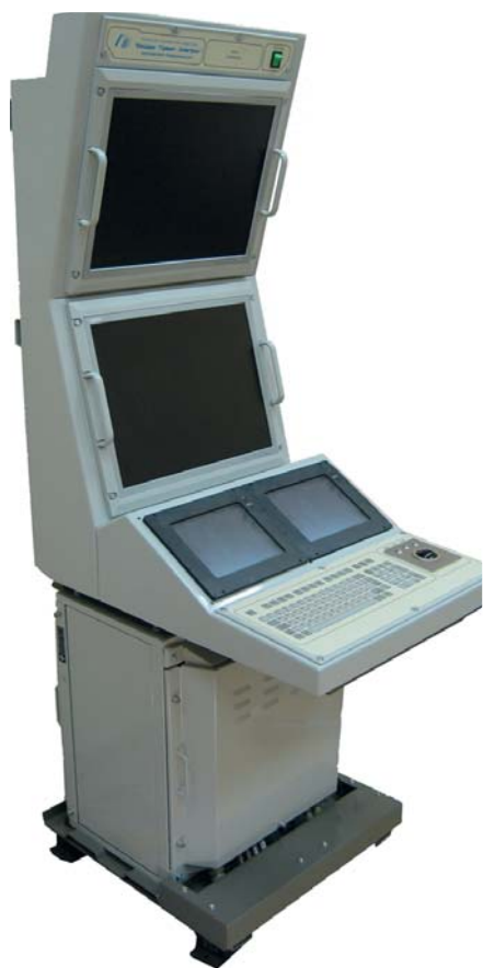
Рис. 6. УППУ для судовой радиолокационной системы
