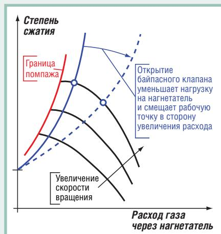
Рис. 2. ГДХ центробежного нагнетателя при управлении байпасным клапаном
