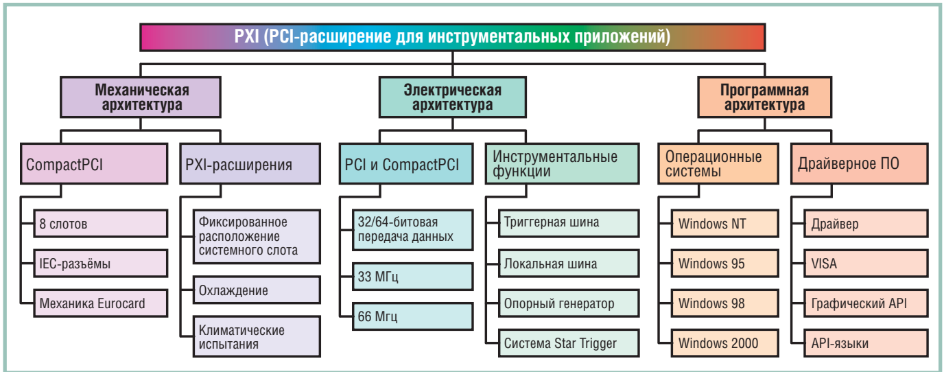
Рис. 4. Программно-аппаратные возможности, определяемые стандартом PXI
