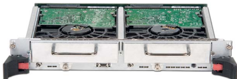
Рис. 4. Модули хранения данных CPC5900/CPC5910 с поддержкой RAID для систем CompactPCI 6U
