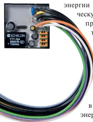
**Рис. 13. Модуль ввода-вывода DI6UP с LON-интерфейсом**
