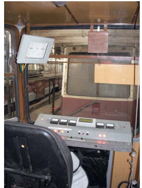
Рис. 6. Рабочее место водителя трамвая с установленным компьютером бортовой информационно-вычислительной системы
