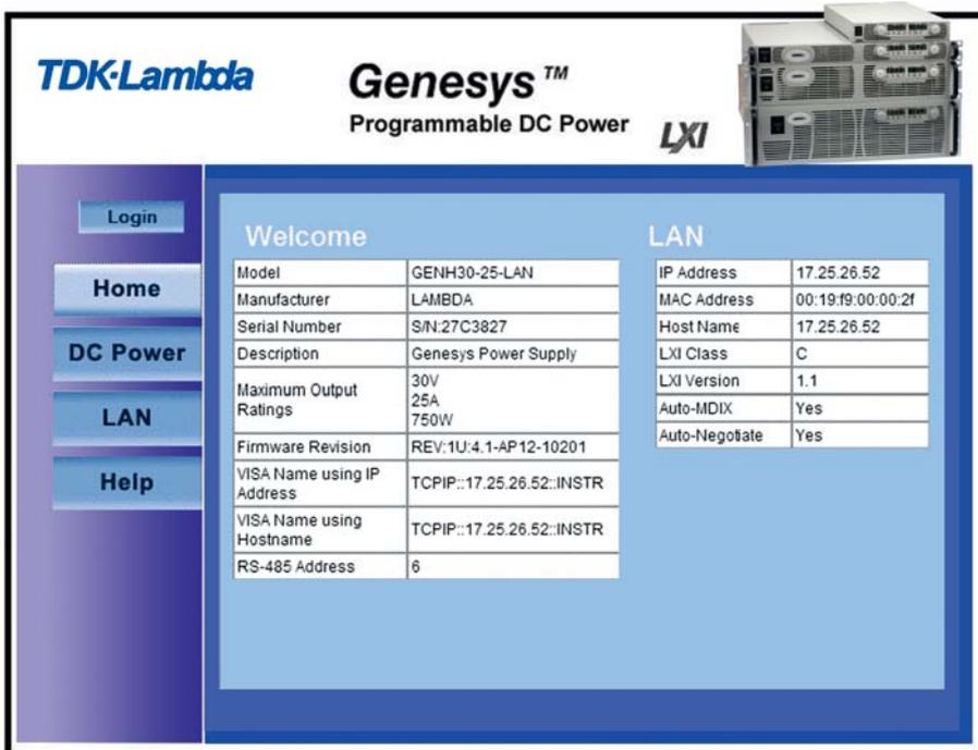
Рис. 6. Web-панель управления источником питания серии Genesys
