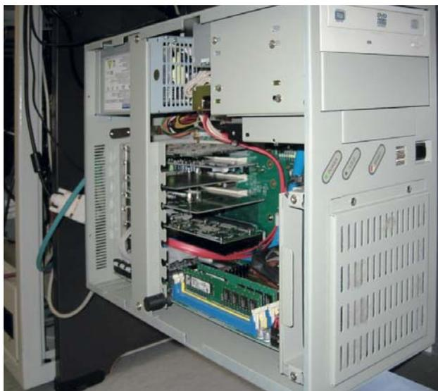
Рис. 4. Системный блок АРМ ШН (боксовая крышка корпуса АРС-6608 снята для демонстрации внутренней конструкции блока)
