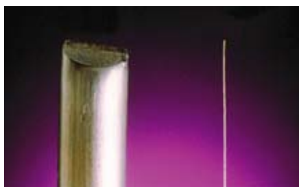
Рис. 1. Исходная заготовка и конечный продукт — проводник AWG 44
