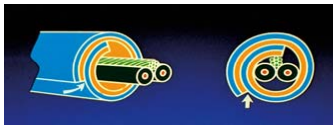
Рис. 8. Технология Beldfoil® (оранжевым цветом показана фольга, синим — изолирующая полимерная плёнка)
