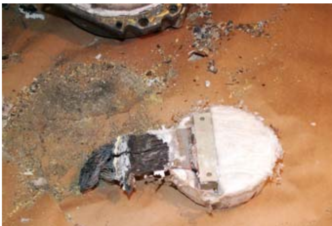
Рис. 3. Модуль флэш-памяти ЗН-МС-1, извлечённый из защитной капсулы после высокотемпературного пожара (модуль флэш-памяти сохранил работоспособность после этих испытаний)
