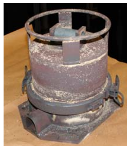
Рис. 2. ЗН-МС-1 после высокотемпературного пожара
