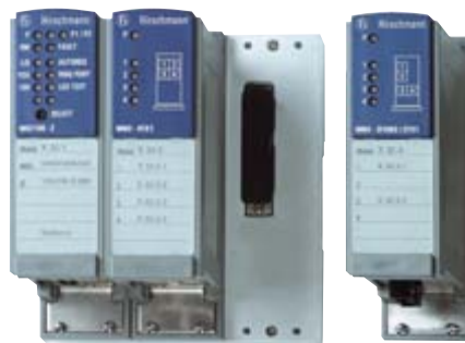
Рис. 1. Модульные управляемые коммутаторы MICE и Power MICE для промышленных сетей
