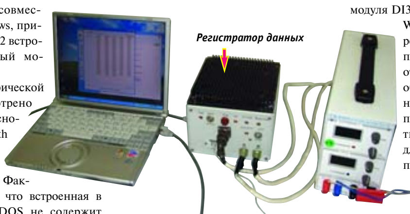
Рис. 6. Регистратор данных, ноутбук и блок питания (этап лабораторной наладки)
