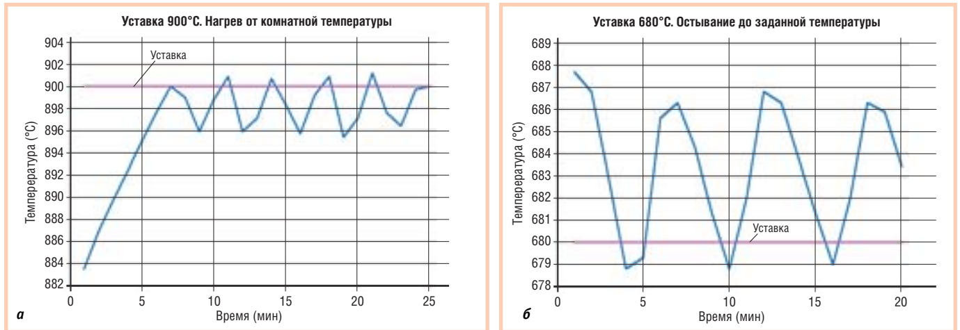
Рис. 4. График колебания температуры при регулировании пороговым элементом: а — уставка 900°С, выход с меньшей температуры на более высокую; б — уставка 680°С, выход на требуемую температуру с более высокой
