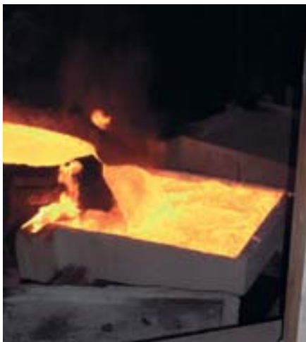
Рис. 4. Так отливаются аноды (заполнение изложницы медью)
