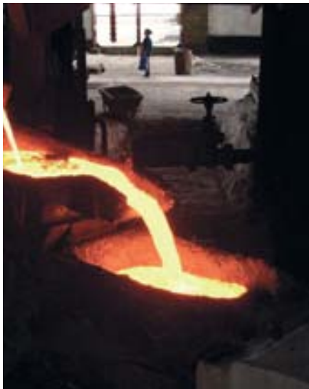
Рис. 3. Заполнение медью дозировочного ковша
