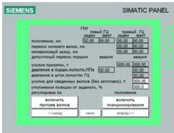
Рис. 3. Видеокادر «Гидромеханическое нажимное устройство» панели оператора
