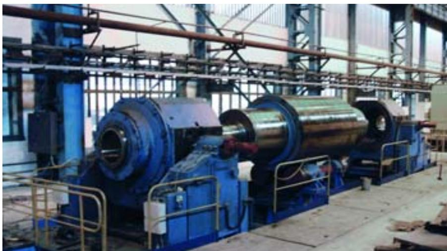
Рис. 1. Общий вид стана сборки-разборки рабочих и опорных валков
