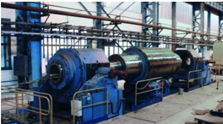
Рис. 1. Общий вид стендса сборки-разборки рабочих и опорных валков
