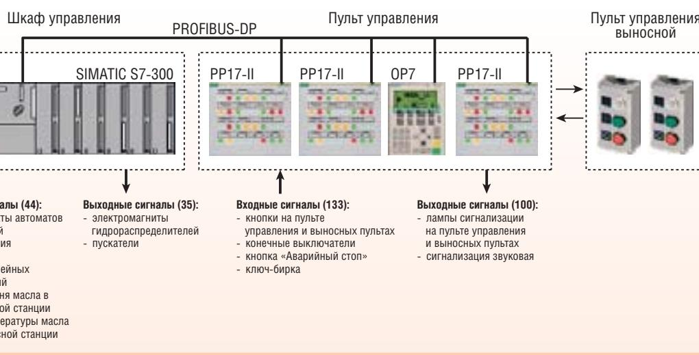
Рис. 3. Структурная схема системы управления стендом сборки-разборки опорных и рабочих валков
