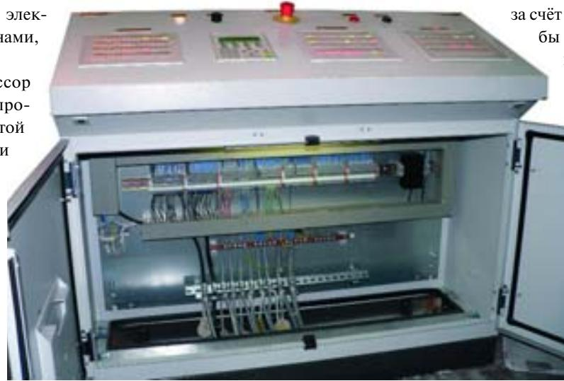
Рис. 5. Пульт управления стенда сборки-разборки опорных и рабочих валков
