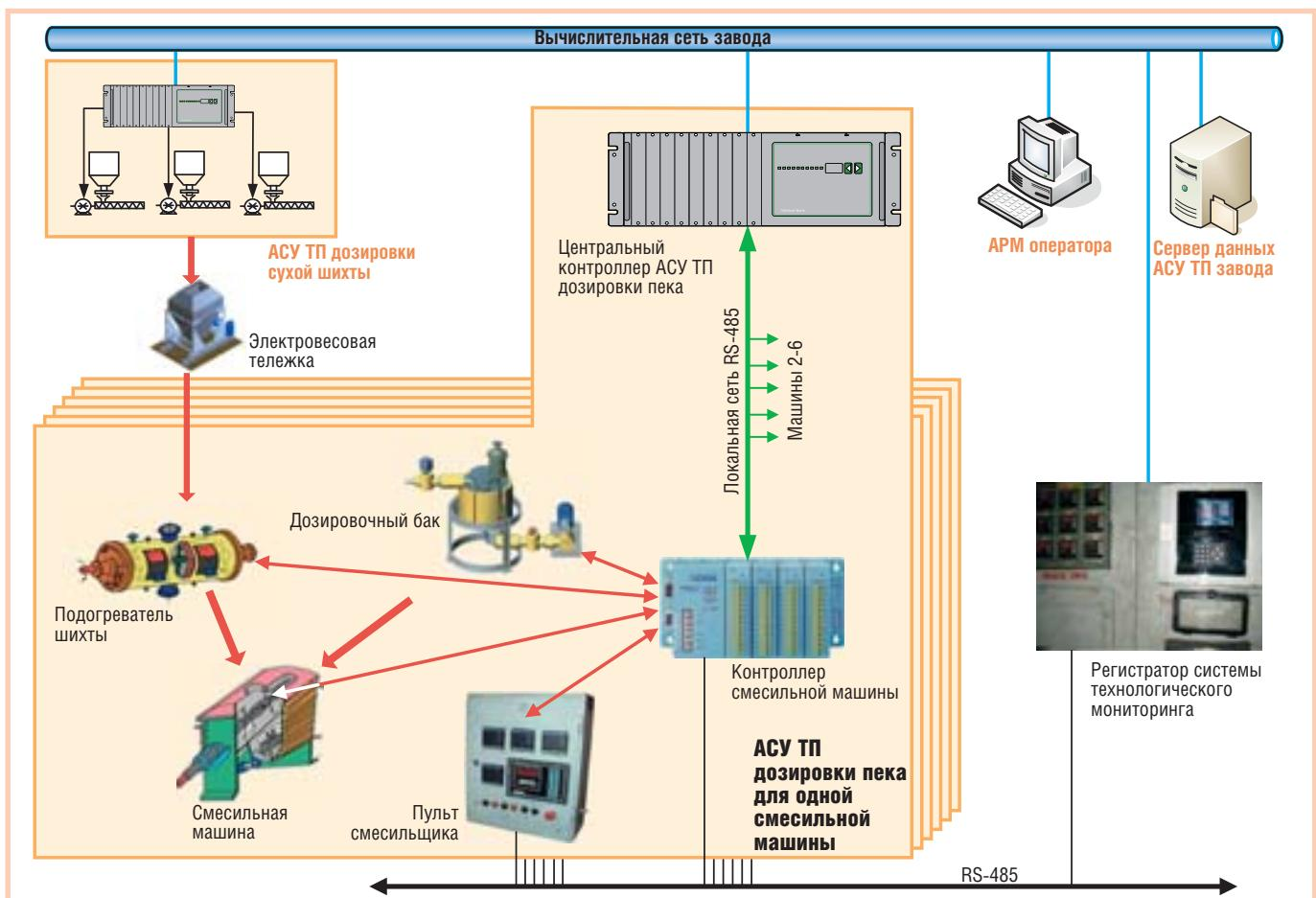
Рис. 4. Структура АСУ ТП дозировки пека
