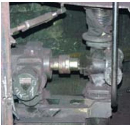
**Рис. 2. Внешний вид крана-дозатора, установленного вместо сливного пневмоклапана**
