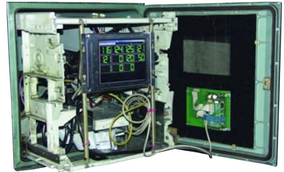
Рис. 7. Регистратор системы технологического мониторинга
