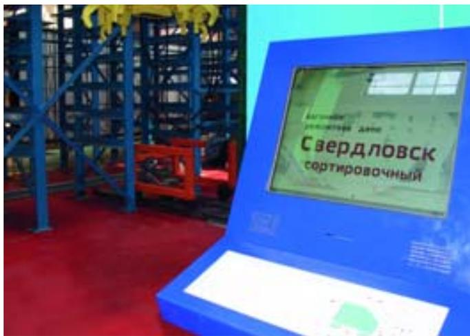
Рис. 4. Пульт управления поперечным краном подсистемы № 11
