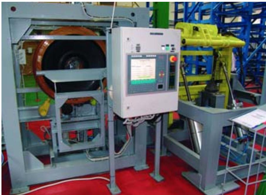
Рис. 3. Установка входного контроля параметров колёс
