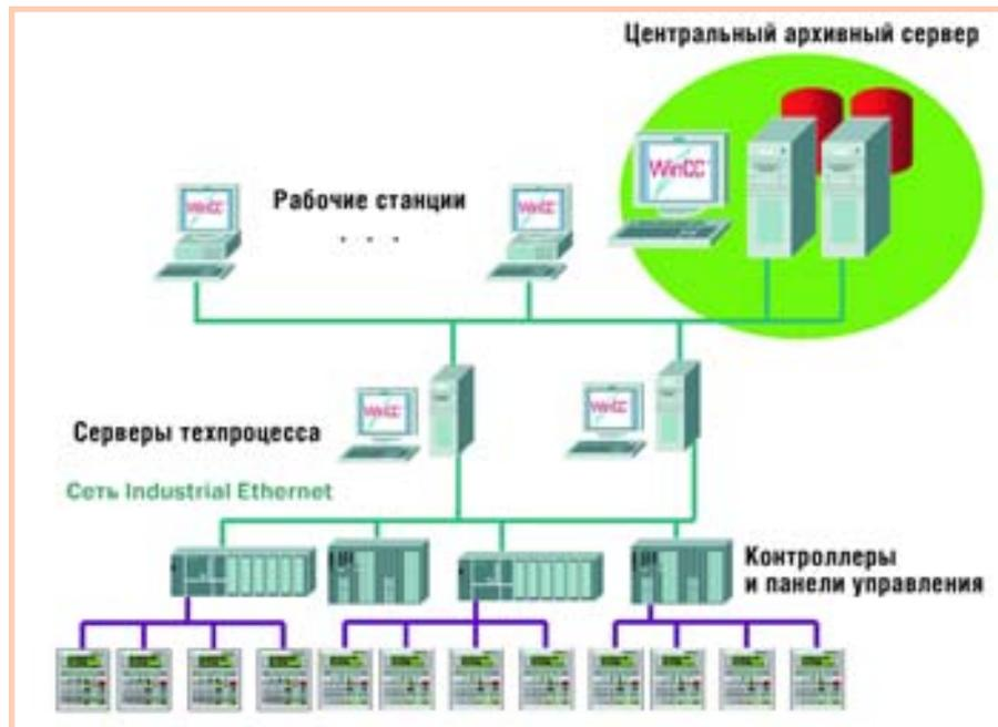
Рис. 5. Структурная схема АСУ МСТО ВКМ депо Свердловск-Сортировочный
