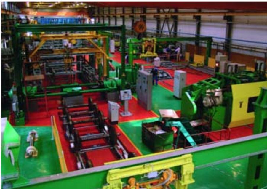
Рис. 2. Общий вид вагонно-колёсных мастерских депо Свердловск-Сортировочный, оснащённых автоматизированной системой управления межстаночным технологическим оборудованием
