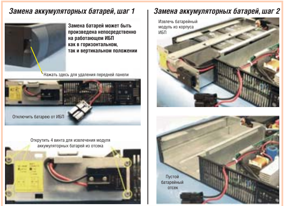
Рис. 11. Замена аккумуляторных батарей
