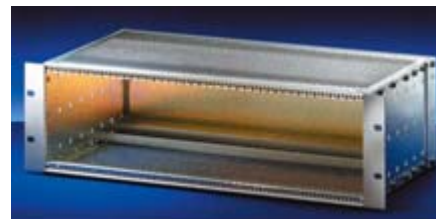
Рис. 11. Экранированный блочный каркас 3U CompactPCI 24563-157 (Schroff). Поставляется в виде набора деталей. Направляющие, объединительная плата и лицевые панели в комплект не входят
