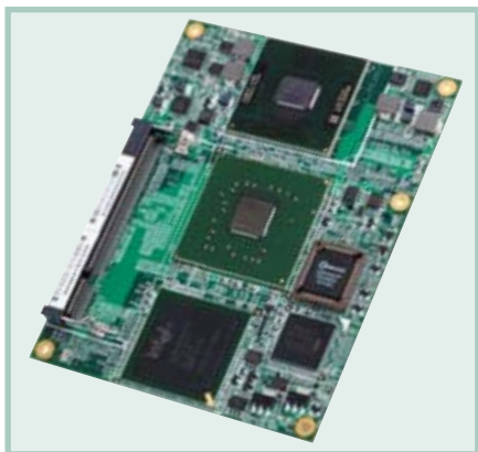
Рис. 1. Внешний вид модуля SOM-5782 компании Advantech (формат COM Express, процессор Intel Core 2 Duo)
