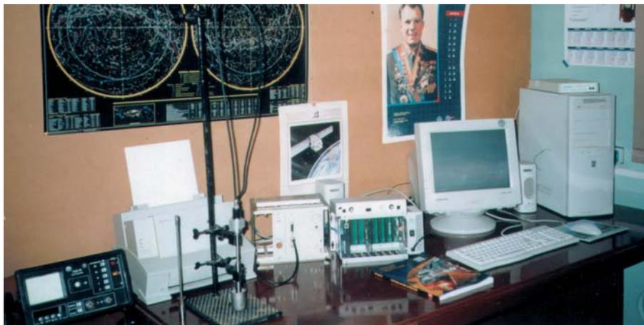
Рис. 1. Опытный образец бортового терминала на этапе наземных испытаний
