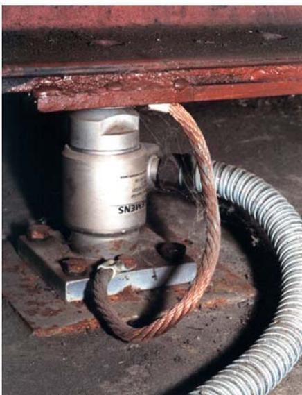
Рис. 1. Тензометрический датчик SIWAREX R с узлом встройки
