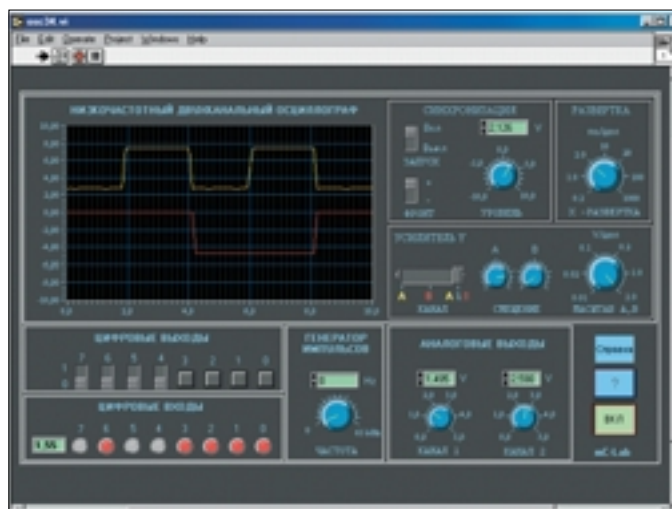
Рис. 7. Копия экрана с виртуальным осциллографом
