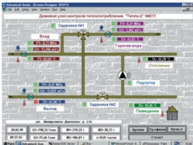
Рис. 6. Мнемосхема системы контроля теплоснабжения, разработанной в среде Genie в рамках курсового проекта
