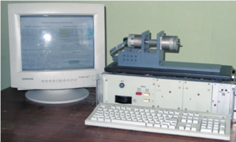
Рис. 9. Комплекс для исследования быстродействующих интеллектуальных приводов
