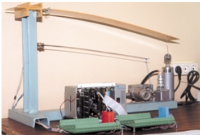
Стенд моделирования и исследования контуров регулирования АСУ ТП
