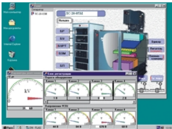
Условные обозначения: БР — блок регистрации; БУ — блок управления; БУРТ — блок управления рентгеновской трубкой; БУМ — блок усилителей мощности; БП — блок подключения; Тр. вода — транспортная вода
