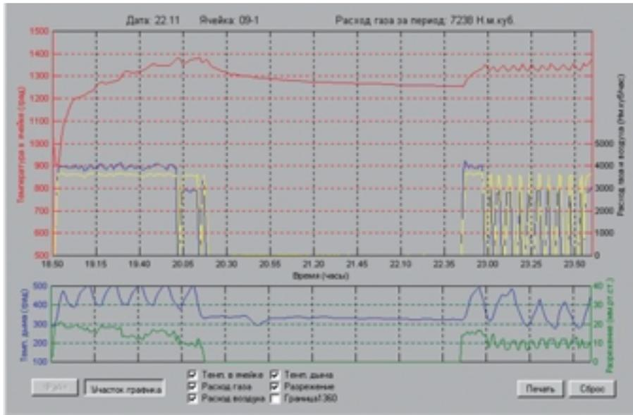
Рис. 11. Тренды технологических параметров нагрева ячейки 9-1 с 18:50 до 24:00 22.11.2000
