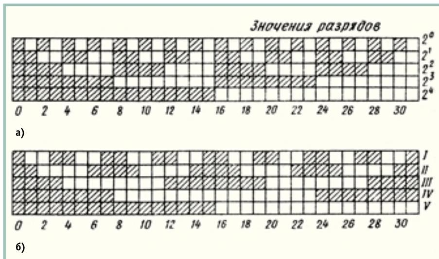
Рис. 2. Примеры кодирующих линейчатых масок: а — двоично-кодированная маска; б — маска в коде Грея
