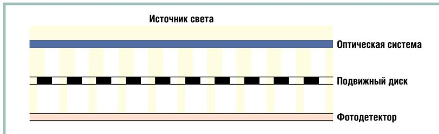
Рис. 12. Интерферометрический метод создаёт тонкие параллельные полосы света на очень коротких расстояниях
