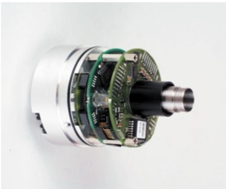
Внешний вид конструкции электронной части абсолютного шифратора
