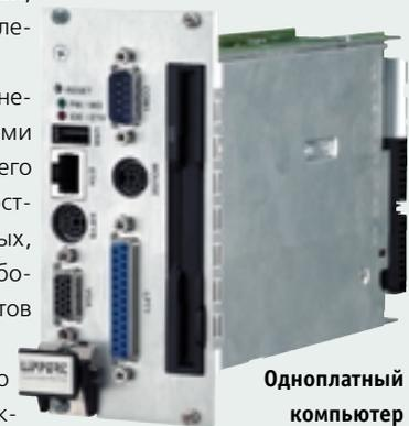
Одноплатный компьютер с шиной AT96
