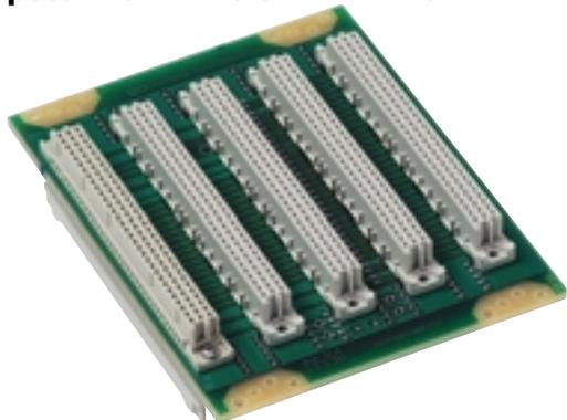
Для систем AT96 фирма Lippert поставяет кросс-платы с различным количеством слотов (3/5/6/8), кросс-платы со специальными слотами для источников питания (ZN) или без них (Z). Для подключения источников питания используются соединители типа H15 (кросс-платы версии ZN) или соединители типа FASTON (кросс-платы версии Z).
