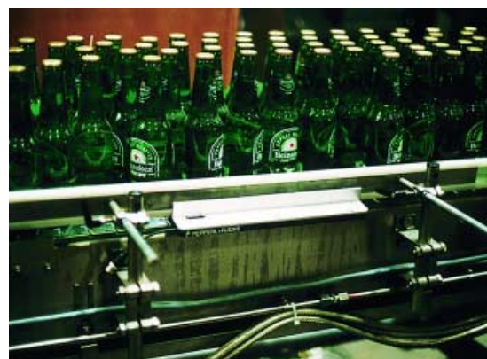
Фотоэлектрические датчики на заводах KRONES
