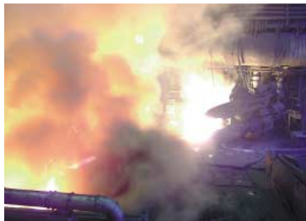
Рис. 5. Выпуск чугуна из доменной печи
