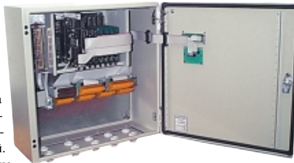
Рис. 4. ЭКОМ-3000 в стальном промышленном шкафу Schroff
