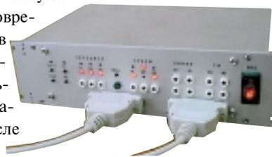
Рис. 1. Многофункциональный модем ЦМТ-3
