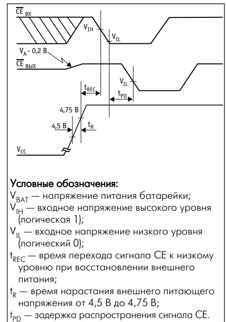
Рис. 3. Временные диаграммы перехода в режим питания от внешнего источника
