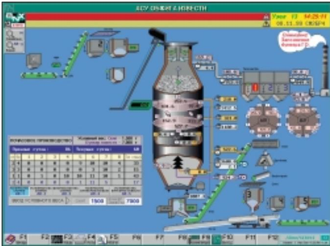
Рис. 2. Главная панель АСУ обжига известки
