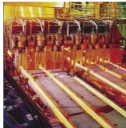
Машина непрерывного литья заготовок (МНЛЗ)
