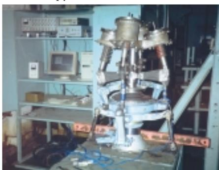
Рис. 2. Стенд для испытаний на износ автомата перекоса
