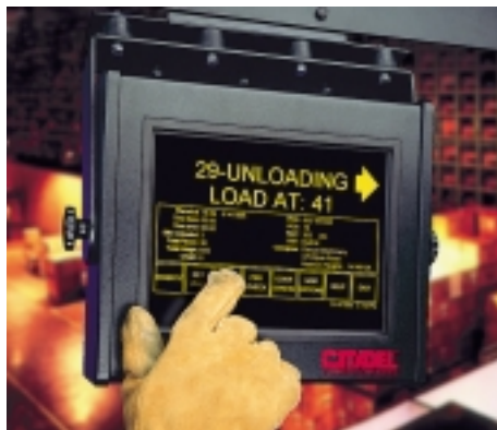
Дисплей EL640.480-AM8 внутри морозильной камеры
