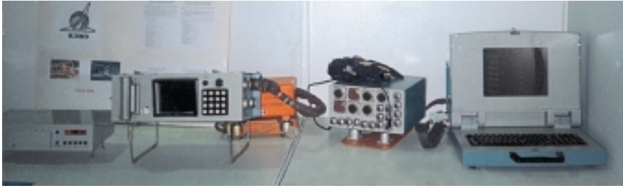
Устройство «Дозор» и пульт диагностики систем самолета с встроенными дисплеями EL640.480-AA1 и EL320.256-FD7-AG
