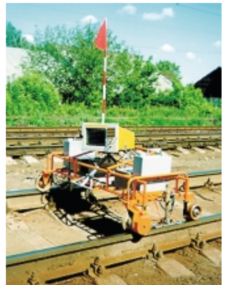
Дефектоскопическая система АДС-02 с дисплеем EL640.480-AM8-SK
