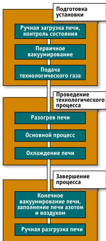
**Рис. 6. Укрупненная блок-схема технологического процесса термической обработки**
