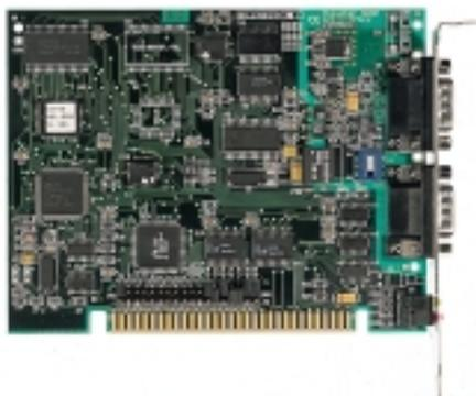
Семейство IBM PC совместимых контроллеров (CIF — Communication InterFace) фирмы Hilscher для построения сетей CANopen, DeviceNet и SDS
