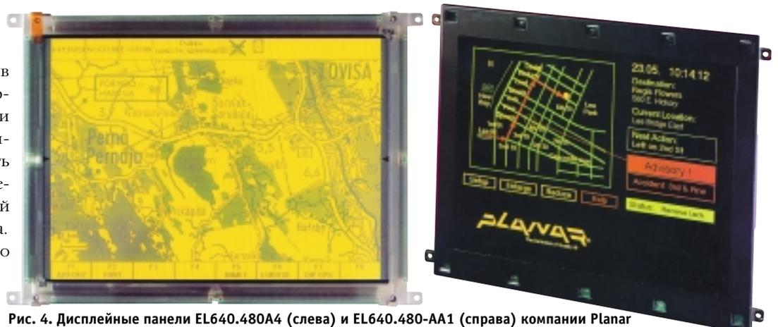
Рис. 4. Дисплейные панели EL640.480A4 (слева) и EL640.480-AA1 (справа) компании Planar
