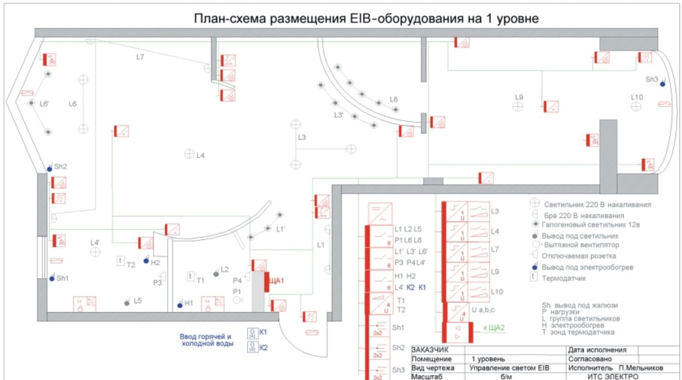
Рис. 7. Проектирование системы EIB на базе ETS: формирование и размещение набора шинных приборов
