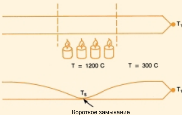
Рис. 18. Локальный нагрев термопары и изменение сопротивления
