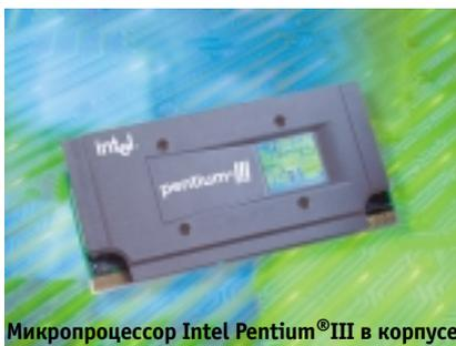
Микропроцессор Intel Pentium®III в корпусе
