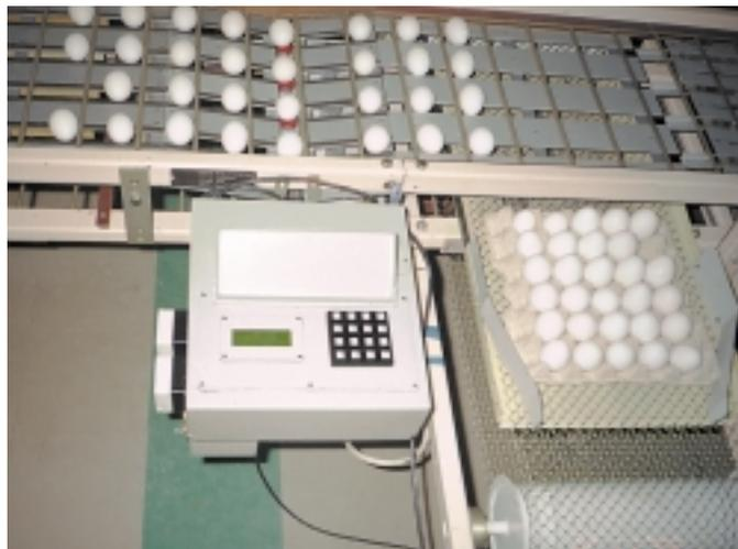
Рис. 3. Измерительно-управляющий модуль МС3-18И
