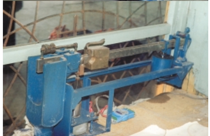
Рис. 3. Модули аналогового ввода могут размещаться в непосредственной близости от весоизмерительных датчиков
