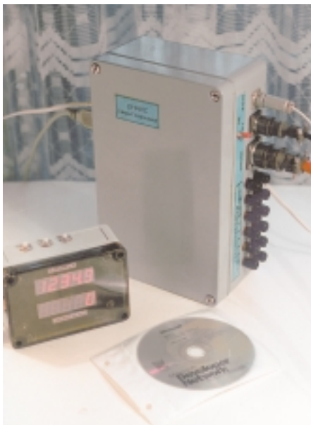
Малогабаритный интерфейсный блок с индикатором глубины и скорости
